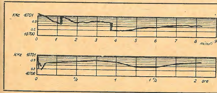
FIG. 5. - Andamento della frequenza in funzione del tempo nel passaggio da freddo a caldo.
